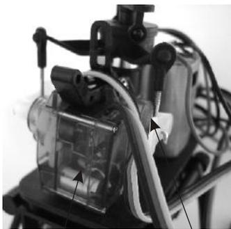
Elevator Servo Aileron Servo
